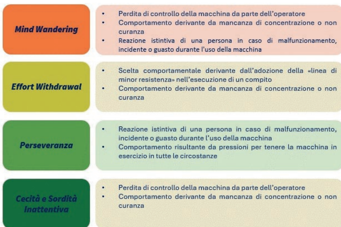
Figura 2 Costrutti cognitivi comportamenti di cui alla norma UNI EN ISO 12100-1 Punto 5.5.1 lettera c
